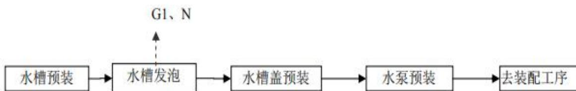
图 2.8-1 水槽生产工艺流程及产污环节
