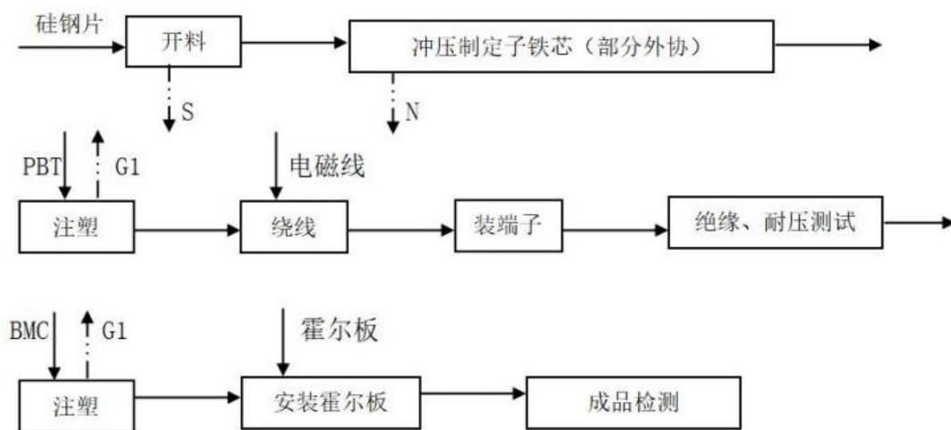
图 2.4-10 DDM 型定子工艺流程图
