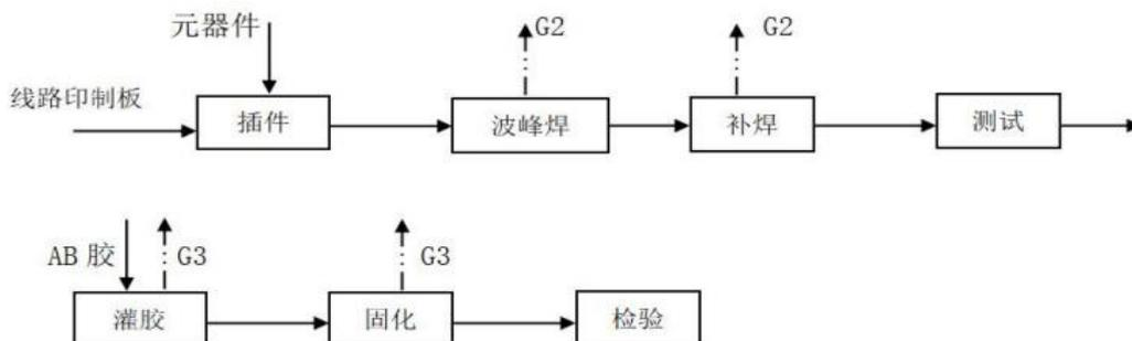
图 2.4-13 变频电机控制器工艺流程图
