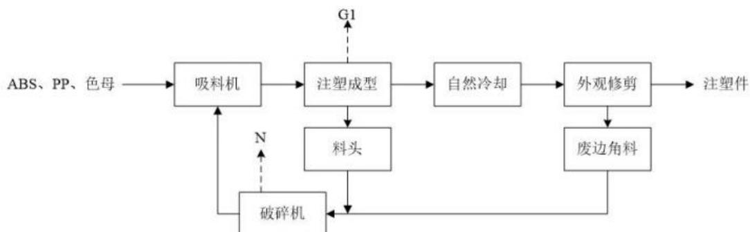
图 2.4-1 注塑生产工艺流程图
