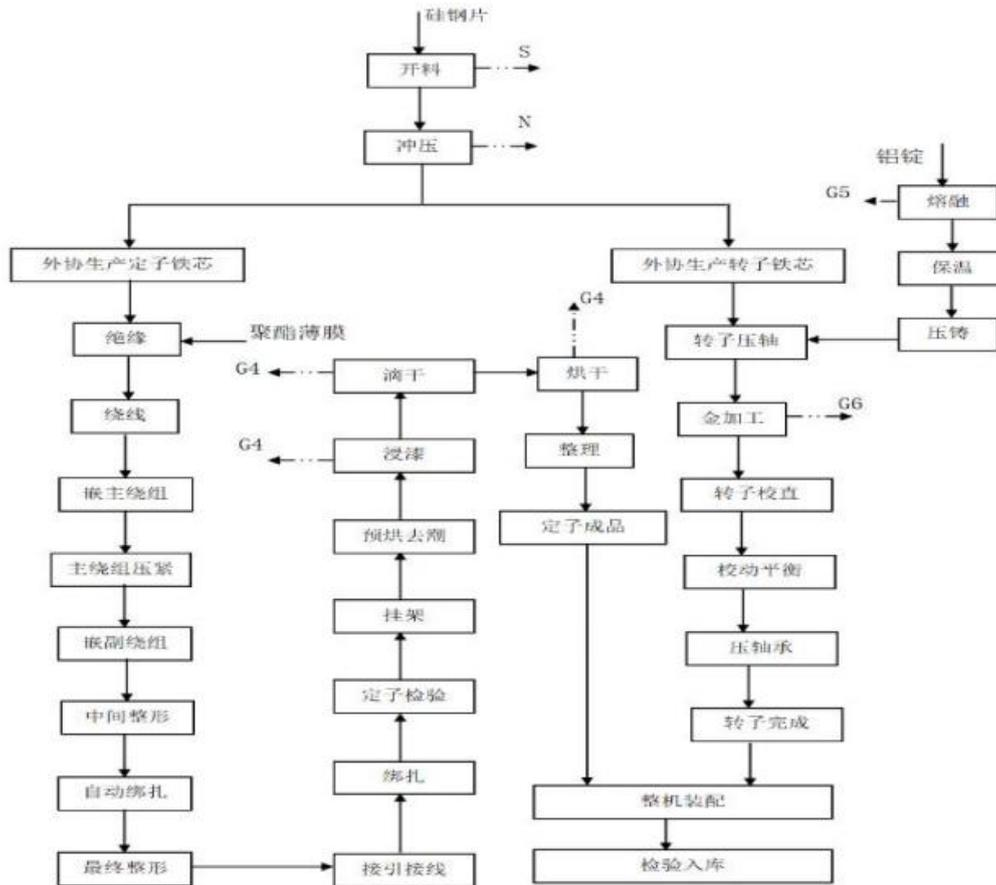
图 2.4-14 异步电机工艺流程图
