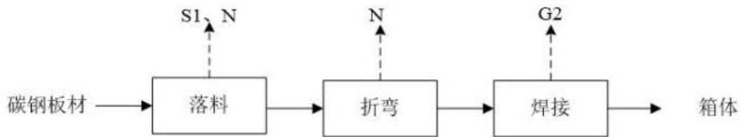
图 2.4-3 洗衣机箱体生产工艺流程图
