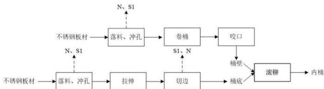
图 2.4-2 不锈钢内桶生产工艺流程图
