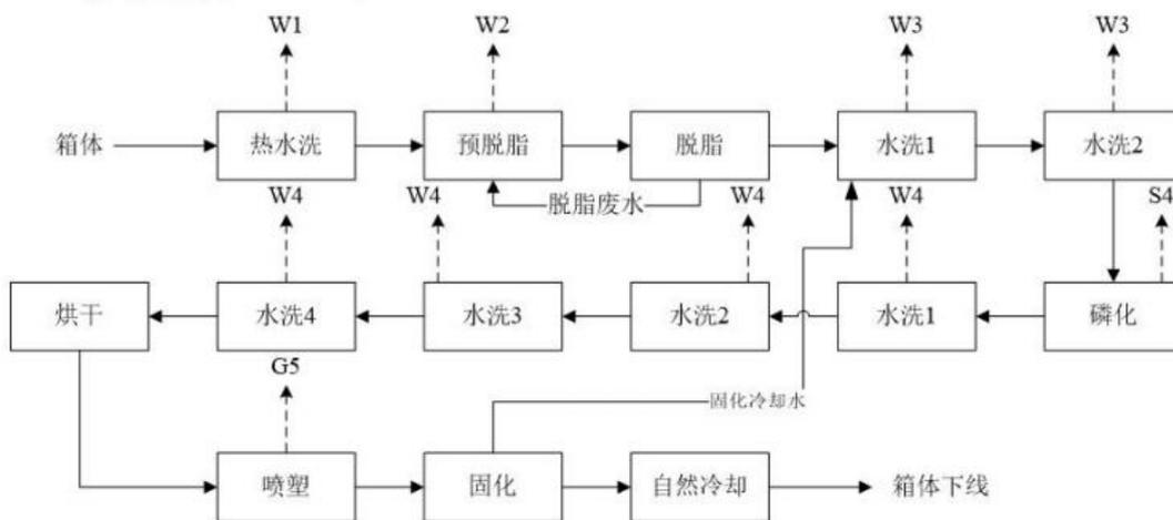
图 2.4-5 箱体喷粉工艺流程图
