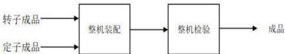
图 2.4-12 DDM 型电机组装工艺流程图
