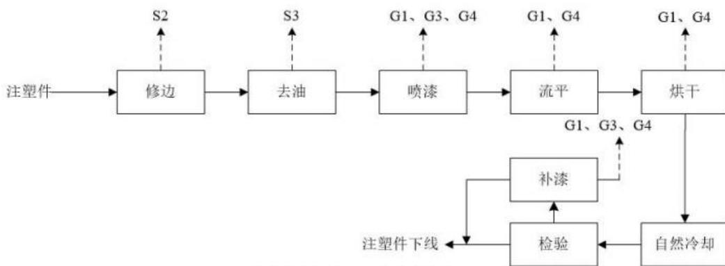
图 2.4-4 注塑件装饰工艺流程图
