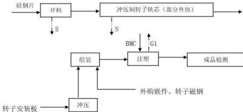
图 2.4-11 DDM型转子工艺流程图
