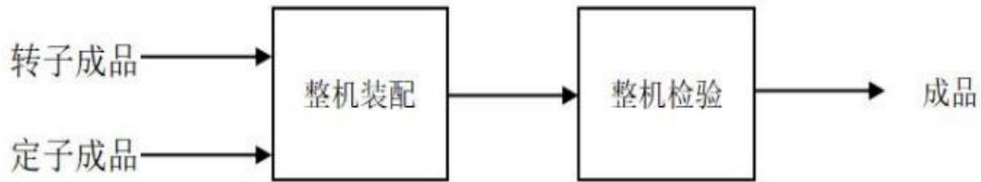
图 2.4-9 DD型电机组装工艺流程图
