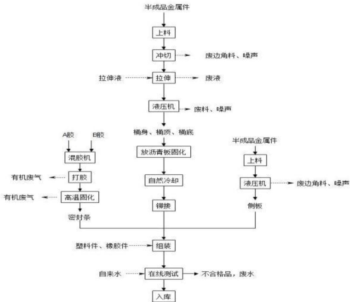
图2.4-6 洗碗机工艺流程图
